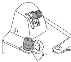
9 Quando il motore è avviato, riportare gradualmente in avanti il pomello dello starter. Lasciar andare il motore ad un regime moderato, "a mezzo gas", per 3-5 minuti prima di raggiungere un carico molto elevato.
