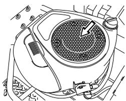
Controllare che il condotto dell'aria posto sul fondo della scocca del motore sia pulito e non sfregi contro la presa d'aria.
