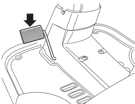
Il movimento delle lame non è disinnestato dal pedale.
