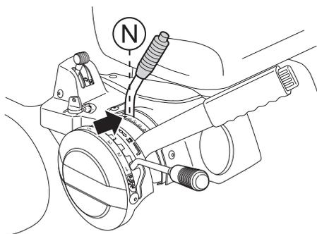
Per ingranare la retromarcia occorre tenere premuto il pulsante di bloccaggio sulla leva del cambio.
