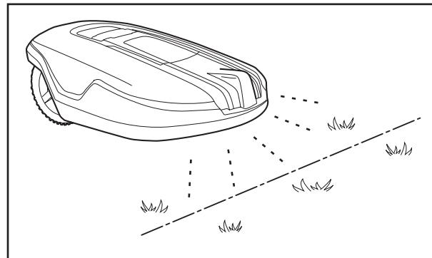
Два дополнительных датчика, один из которых находится спереди, другой — сзади роботизированной газонокосилки Automower®, используются для обнаружения ограждающего провода при движении газонокосилки. Газонокосилка-робот наезжает на провод примерно на 25 см прежде чем повернуть. Длину наезда можно установить, для этого см. параграф Через провод (3-4-2) на стр. 54.
