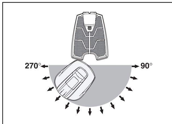
Automower® 260 ACX оборудована ультразвуковыми датчиками, которые эффективно обнаруживают как неподвижные, так и движущиеся препятствия, которые могут встречаться во время работы газонокосилки. При обнаружении препятствия газонокосилка снижает скорость, чтобы избежать сильного удара. Когда газонокосилка-робот натыкается на препятствие, она включает задний ход и выбирает новое направление.
