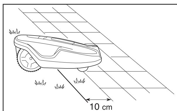
Когда рабочая зона разделена плоской дорожкой, покрытой плиткой, находящейся вровень с газоном, косилка может переезжать через дорожку. В этом случае, возможность проложить провод под плиткой будет преимуществом. Ограждающий провод можно также уложить в стыки между плитками.
