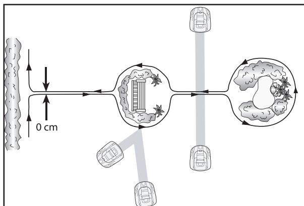
Препятствия, которые могут выдержать столкновение, например, деревья или кусты, высотой свыше 15 см, не нужно обозначать ограждающим проводом. Газонокосилка-робот повернет в другую сторону, столкнувшись с этим типом препятствий.
