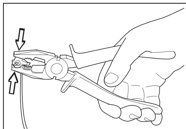
5. Отрежьте все свободные концы ограждающего провода. Оставьте 1-2 см провода над соответствующим устройством соединения.
