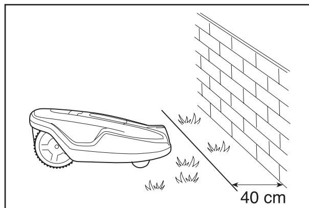
Если рабочая зона граничит с небольшой канавой, например, с цветочной клумбой, или областью небольшого подъема, например низкой каймой из дерна (3-5 см), ограждающий провод необходимо проложить на 35 см внутри рабочей зоны. Таким образом, колеса не будут попадать в канаву или налезать на край каймы из дерна.
