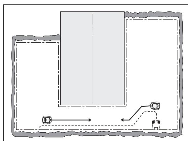
Такое же минимальное расстояние (40 см) должно сохраняться между направляющим проводом и направляющим проводом на дорожке.
