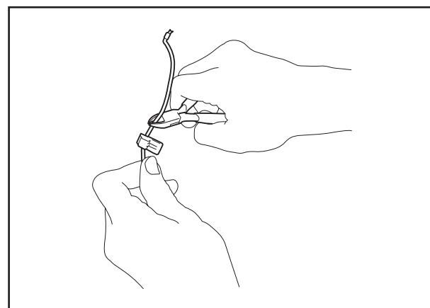
6. Наденьте соединительное устройство на штырек, отмеченный буквой А, на зарядной станции.
