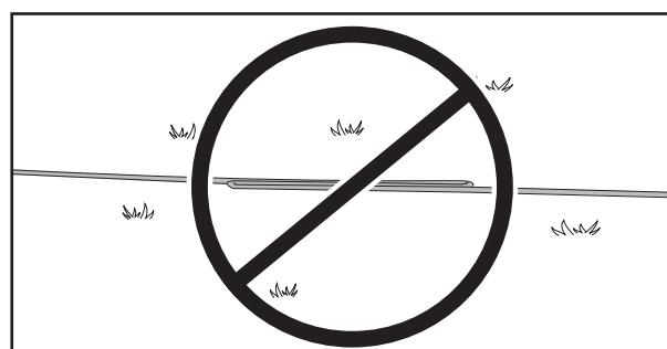
Ограждающий провод должен иметь точку переезда по дороге к и от островка.
