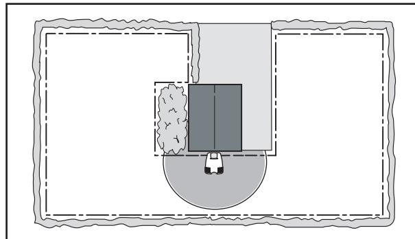
Когда аккумуляторы полностью заряжаются, косилка движется назад, поворачивается и покидает зарядную станцию в направлении, выбранном произвольно, в пределах сектора выхода в  $90^{\circ} - 270^{\circ}$ .
