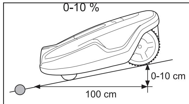
Нельзя прокладывать ограждающий провод через уклон, если он больше 10%. В этом случае газонокосилка-робот не сможет повернуться на нем. Косилка остановится и пошлет сигнал «За пределами рабочей зоны». Риск возникновения такой ситуации повышается в условиях большой влажности, когда колеса скользят по мокрой траве.
