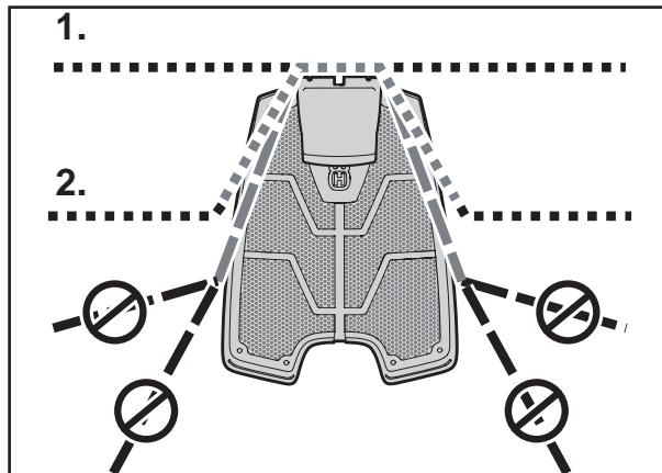
При подключении к зарядной станции правый край ограждающего провода необходимо подвести к правому отверстию, левый край кабеля - к левому отверстию станции.
