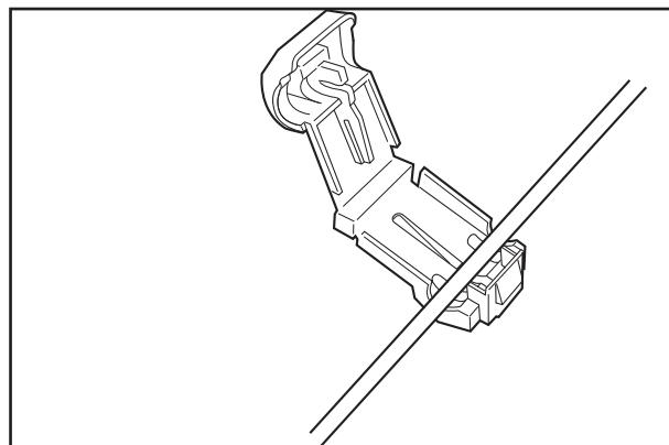
4. Сожмите обе части соединительного устройства, используя плоскогубцы. Зажимайте до тех пор, пока не услышите щелчок.
