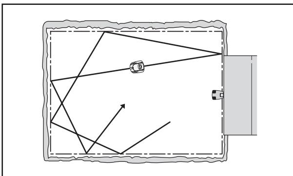
Если газонокосилка-робот въезжает в зону, в которой, по ее определению трава длиннее, чем в ранее обработанных зонах, она может сменить схему движения. Она может двигаться по квадрату, чтобы более равномерно покрывать область с более высокой травой.
