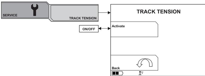
Halten Sie die Wahl taste für die Aktivierung der Kettenspannung gedrückt.
