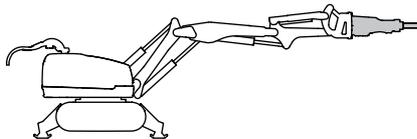
Die Maschine sollte mit Werkzeugen bestückt werden, die für die auszuführenden Arbeiten geeignet sind. Die Anforderungen an Gewicht und Leistungsfähigkeit eines Werkzeugs sind entscheidend, um zu bestimmen, ob es für die Anwendung mit der Maschine geeignet ist. Weitere Informationen hierzu erhalten Sie in den Abschnitten „Werkzeuge“ und „Technische Daten“ sowie den Nutzungsanweisungen des Werkzeugherstellers.
