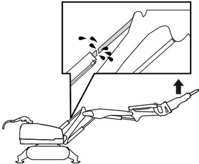
Zylinder 3 wird bis zur äußersten Position gefahren und der Hydraulikhammer ist nach unten gerichtet. Fahren Sie die Zylinder nicht bis zur äußersten Position.
