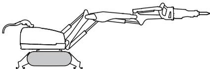
Die Gleisketten werden individuell durch Hydraulikmotoren angetrieben. Durch unterschiedliche Antriebsgeschwindigkeiten der beiden Gleisketten kann die Maschine gedreht werden. Durch unterschiedliche Antriebsrichtungen der beiden Gleisketten ist die Maschine in der Lage, enge Wendemanöver durchzuführen. Wenn die Fahrfunktion nicht aktiviert ist, sperrt das passive Bremssystem den Antriebsmotor.
