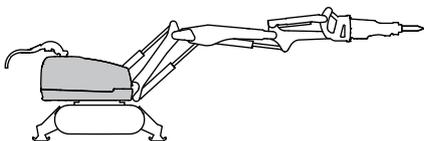
Der Turm lässt sich unbegrenzt drehen, was das Arbeiten in verschiedenen Richtungen ohne Standortwechsel ermöglicht. Die Maschine ist mit einer Schwenkbremse ausgerüstet. Wenn die Drehfunktion nicht aktiviert ist, wird diese durch passive Bremsung gestoppt.
