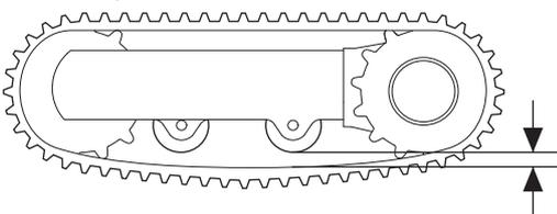
Ein Durchhängen der Gleisketten kann auf blockierte oder defekte Rückschlagventile der Gleiskettenspannfunktion zurückzuführen sein.
