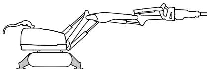
Die Hauptfunktion der Planierschilde ist es, der Maschine Stabilität zu geben. Sie sollten bei jeder Arbeit mit der Maschine verwendet werden.
