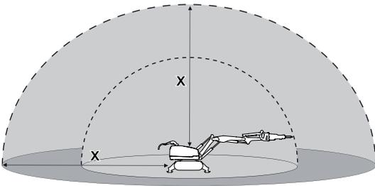
Der Arbeitsbereich stimmt mit der Reichweite der Maschine überein. Dagegen hängt der Umfang des Sicherheitsbereichs von Arbeitsweise, Gegenstand, Untergrund usw. ab. Überprüfen Sie den Arbeitsplatz auf mögliche Gefahren hin. Bei Änderungen der Arbeitsumstände muss der Umfang des Sicherheitsbereichs erneut festgelegt werden.
