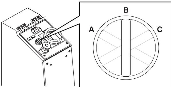
Zur Aktivierung des Fernbedienungsmodus wird der Schalter nach links gedreht (A).
