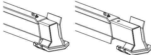
Die Stützauslegerfüße können nach oben zeigend montiert werden. Auf diese Weise können die Stützausleger verwendet werden, ohne dass deren Füße mit dem Boden in Berührung kommen.
