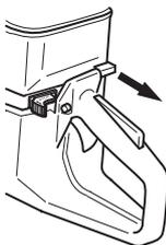
**Posizione di avviamento dell'acceleratore - motore caldo:** La regolazione corretta della valvola dell'aria/ dell'acceleratore si ottiene tirando in fuori il comando dello starter e respingendolo a posto completamente. In questo modo la regolazione dell'acceleratore viene inserita senza alcuna chiusura dell'aria.
