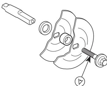
Non usare rondelle distorte, smussate, danneggiate o sporche. Non usare rondelle di diverse dimensioni.
