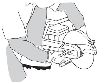
La vite di fissaggio del disco deve venir serrata con una coppia pari a 15-25 Nm.
