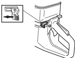
**Posizione di avviamento dell'acceleratore - motore freddo:** Per la posizione di avviamento dell'acceleratore e la chiusura dell'aria è necessario estrarre completamente la valvola dell'aria.
