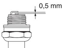
N.B! Usare candele originali o di tipo raccomandato! Altre candele possono danneggiare cilindro e pistone.
