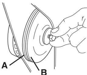
Per bloccare l'albero usare un cacciavite, una spina di acciaio o simili, spingerlo poi per quanto possibile. Serrare il disco in senso orario.
