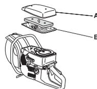
Rimuovere il filtro in materiale espanso. Pulire il filtro accuratamente con acqua saponata tiepida. Dopo la pulizia, risciacquare il filtro accuratamente con acqua pulita. Strizzare il filtro e lasciarlo asciugare. N.B! L'aria compressa usata a pressione troppo elevata può danneggiare il filtro in materiale espanso.
