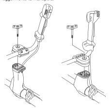
Indossare l'imbracatura ed appendere la macchina al suo gancio di sospensione. Eseguire ora una regolazione finale in modo da ottenere una comoda posizione di lavoro con la macchina sospesa all'imbracatura
