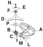
Avvitare la coppetta di sostegno (E) sulla filettatura dell'alberino sporgente (NOTA! Filettatura sinistrorsa). Serrare con una coppia di 35-50 Nm (3,5-5,0 kpm). Usare la chiave a bussola inclusa nel kit attrezzi. Notare che la spina di bloccaggio (C) deve restare nell'alloggiamento del riduttore per bloccare il menabrida. Mantenere il manico della chiave il più vicino possibile al paralama/protezione multipla.
