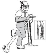
Durante l'affilatura fare in modo di avere un buon appoggio per la lama. Usare una lima tonda da 5,5 mm ed un supporto per lima.
