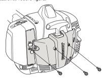
Rimuovere il filtro dell'aria e il relativo coperchio dalla macchina. Installare il filtro dell'aria e il relativo coperchio contenuti nel kit invernale
