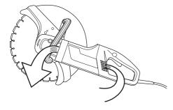
Affinché la macchina mantenga costantemente un raffreddamento ottimale, è necessario mantenere pulite le aperture per l'aria. Pulire regolarmente la macchina usando aria compressa.
