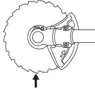
Svitando e avvitando il dado della lama per sfrascatura c'è pericolo di ferirsi con i denti della lama. Accertarsi quindi che la mano sia riparata dal paralama durante questa operazione. A questo proposito utilizzare sempre una chiave a bussola dal manico sufficientemente lungo. La freccia in figura mostra la zona di utilizzo della chiave a bussola quando si avvita e si svita il dado.
