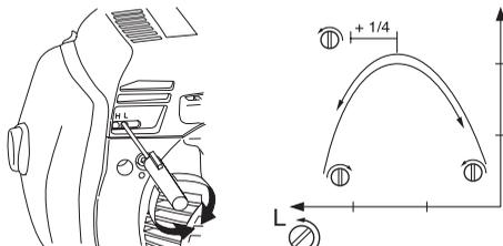
**N.B!** Se il gruppo di taglio ruota con il motore al minimo sarà necessario regolare la vite T in senso antiorario fino all'arresto del gruppo di taglio.
