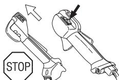
Mettere in moto e controllare che il motore si spenga portando l'interruttore in posizione di arresto.
