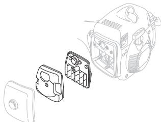
Se la macchina viene utilizzata in ambienti molto polverosi deve essere utilizzato un filtro in schiuma lubrificato (accessorio). Per la lubrificazione, vedere istruzioni alla voce Lubrificazione del filtro dell'aria.
