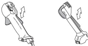
Controllare che acceleratore e fermo del gas si muovano liberamente e che le molle di richiamo funzionino a dovere.
