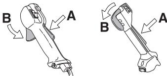
Controllare che l'acceleratore sia bloccato sul minimo quando il fermo è in posizione di riposo.
