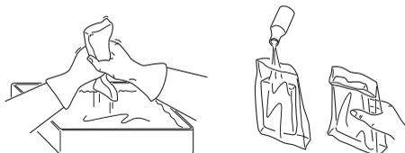
Il filtro non ritorna mai completamente pulito. Pertanto va sostituito periodicamente con uno nuovo. **Un filtro danneggiato va sostituito immediatamente.**
