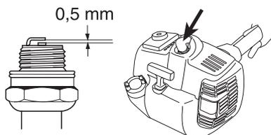
**N.B!** Usare candele originali o di tipo raccomandato! Altre candele possono danneggiare cilindro e pistone. Controllare che la candela sia munita di dispositivo di soppressione interferenze radio.
