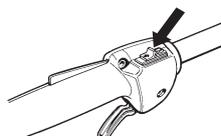
Mettere in moto e controllare che il motore si spenga portando l'interruttore in posizione di arresto.
