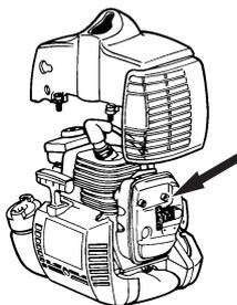
Alcune marmitte sono dotate di una speciale retina parascintille. Se la macchina è dotata di una marmitta di questo tipo, è consigliabile pulire la retina una volta alla settimana. Per un risultato ottimale usare una spazzola di acciaio.
