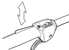
Controllare che acceleratore e fermo del gas si muovano liberamente e che le molle di richiamo funzionino a dovere.
