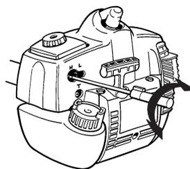
Accelerare a tutto gas e girare l'ugello di alto regime H molto lentamente in senso orario fino a quando la velocità del motore sarà diminuita. A questo punto girare molto lentamente l'ugello di alto regime H in senso antiorario fino a quando il motore assumerà un andamento irregolare. Girare poi lentamente l'ugello di alto regime H un poco in senso orario fino ad ottenere un andamento regolare del motore.
