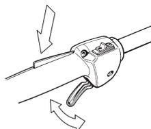
Vedi istruzioni alla voce Avviamento. Avviare il tagliaerba ed accelerare a pieno gas. Lasciar andare l'acceleratore e accertarsi che i coltelli si fermino e restino fermi. Se i coltelli ruotano mentre l'acceleratore è al minimo regolare il minimo nel carburatore. Vedi istruzioni alla voce Manutenzione.
