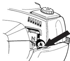
**Aria:** Portare il comando dell'aria in posizione di starter.
