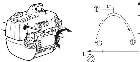
**N.B!** Se le lame si muovono al minimo, girare la vite T in senso antiorario finché le lame non si fermano completamente.
