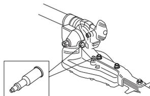
**N.B!** Il riduttore non dev'essere riempito completamente di grasso. Il grasso si espande con il calore proveniente dalla macchina in esercizio. Riempendo completamente il riduttore si corre il rischio di rovinare le guarnizioni o di incorrere in perdite di grasso.
