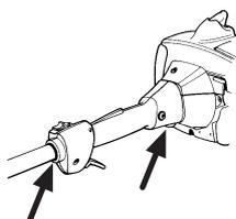
Il sistema di smorzamento delle vibrazioni della macchina ne riduce la propagazione tra gruppo motore/gruppo di taglio e impugnature.
