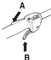
Controllare che l'acceleratore sia bloccato sul minimo quando il fermo è in posizione di riposo.
