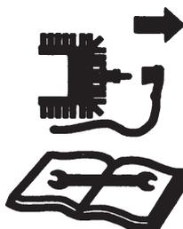
Arrestare il motore e distaccare il cavo di accensione dalla candela prima di eseguire riparazioni o manutenzione
