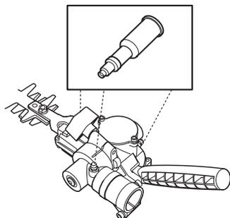
N.B! Il riduttore non dev'essere riempito completamente di grasso. Il grasso si espande con il calore proveniente dalla macchina in esercizio. Riempiendo completamente il riduttore si corre il rischio di rovinare le guarnizioni o di incorrere in perdite di grasso.
