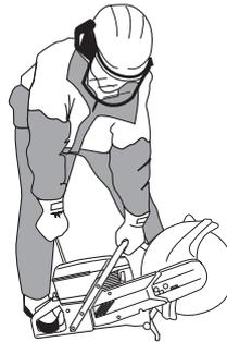
Mit der rechten Hand den Starthandgriff fassen und das Startseil langsam herausziehen, bis ein Widerstand spürbar wird (die Starthaken greifen), und dann schnell und kräftig ziehen.
