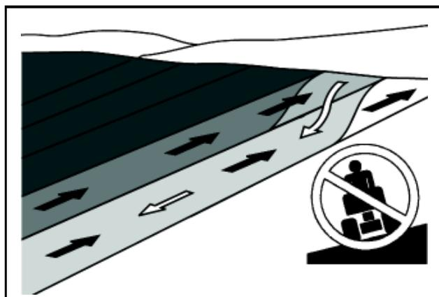
Eseguire la falciatura guidando parallelamente alla direzione di inclinazione del piano <sup>8003-004</sup>
