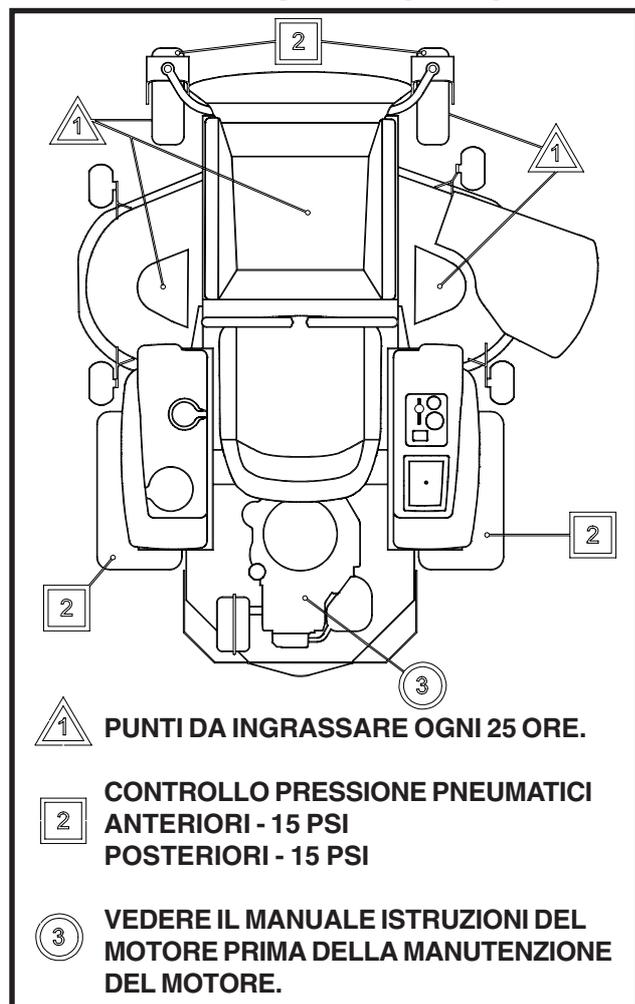
**IMPORTANTE:** NON OLIARE O INGRASSARE I PERNI DOTATI DI CUSCINETTI IN NYLON SPECIALI. I LUBRIFICANTI VISCOSI ATTRAGGONO POLVERE E SPORCIZIA, CHE RIDUCONO LA DURATA DEI CUSCINETTI AUTOLUBRIFICANTI. PER L'EVENTUALE LUBRIFICAZIONE, UTILIZZARE ESCLUSIVAMENTE UN LUBRIFICANTE IN POLVERE A BASE DI GRAFITE, CON PARSIMONIA.
