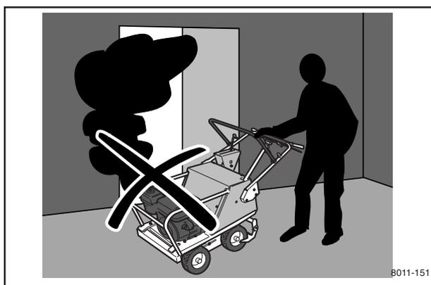
Utilizzare la macchina esclusivamente all'aria aperta o in ambienti con sufficiente ricambio d'aria.
