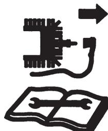
Arrestare il motore e distaccare il cavo di accensione dalla candela prima di eseguire riparazioni o manutenzione
