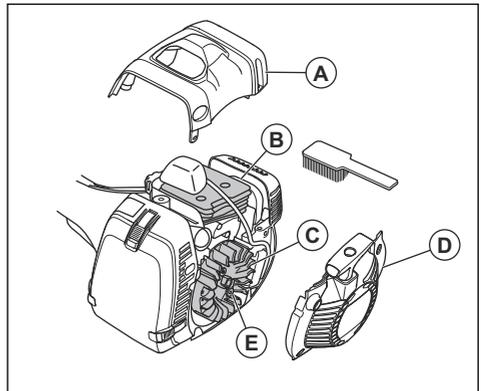
Pulire il sistema di raffreddamento una volta alla settimana o più spesso, se necessario.
