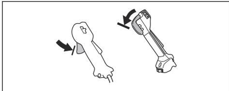
2. Premere il blocco del grilletto acceleratore (A). Assicurarsi che il grilletto acceleratore (B) sia rilasciato.
