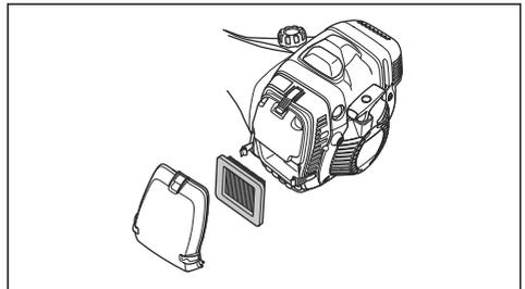
5. Controllare e pulire l'alloggiamento del filtro con una spazzola.
