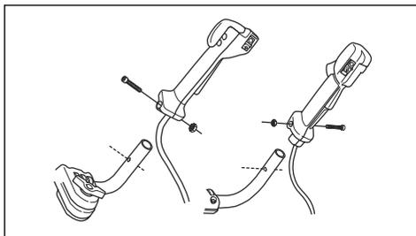
3. Far coincidere il foro della vite di fissaggio dell'impugnatura con il foro del manubrio.
