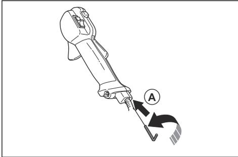
4. Se il regime del gas di avviamento è maggiore di 6500 giri/min, girare la vite di regolazione (A) in senso antiorario. Quando il gruppo di taglio comincia a ruotare, girare la vite di regolazione (A) di ½ giro.
