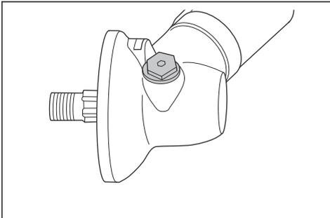
4. Guardare nel foro del tappo di ingrassaggio e ruotare l'albero di trasmissione. Il livello di grasso (A) deve essere a livello con la parte superiore dei denti dell'ingranaggio (B).
