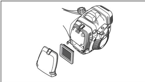
5. Controllare e pulire l'alloggiamento del filtro dell'aria con una spazzola.
