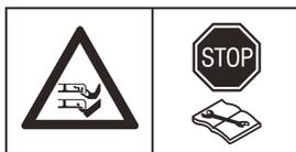
**ПРЕДУПРЕЖДЕНИЕ:** Перед выполнением каких-либо операций с газонокосилкой или ее подъемом задействуйте устройство отключения.
