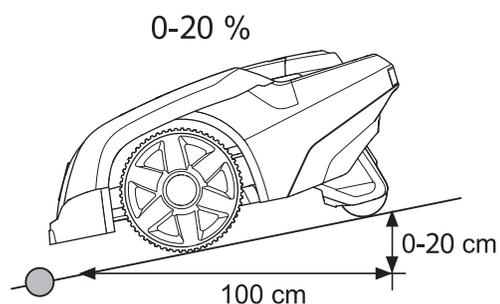
Non sistemare il cavo di limitazione trasversalmente a una pendenza superiore al 20 %, in quanto il rasaerba robotizzato può avere difficoltà a girarsi. In tal caso, il rasaerba si ferma e visualizza il messaggio di guasto Fuori area di lavoro. Quanto detto vale soprattutto se il terreno è umido e sussiste il rischio di slittamento delle ruote.
