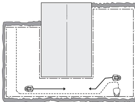
Il rasaerba si sposta sempre verso la sinistra del cavo guida, osservando frontalmente la stazione di ricarica. Il corridoio si trova quindi a sinistra del cavo guida. Durante l'installazione è quindi importante prevedere uno spazio il più libero possibile a sinistra del cavo guida, osservando frontalmente la stazione di ricarica. Non è possibile posizionare il cavo guida a meno di 30 cm dal cavo perimetrale.
