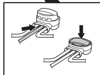
In tal caso, spostare il collegamento del nuovo cavo più vicino all'estremità scollegata (circa al centro della sezione di cavo sospetta) e verificare ancora una volta se la spia è verde o gialla lampeggiante.
