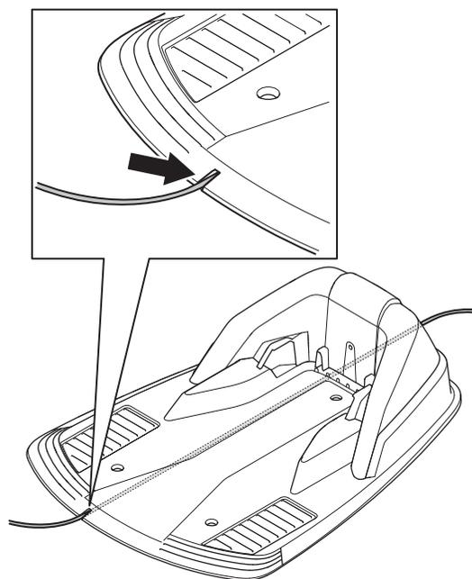
2. Montare il connettore sul cavo guida come già fatto per il cavo perimetrale, seguendo le istruzioni riportate nella sezione **3.5 Collegamento del cavo di limitazione**. Collegarlo al connettore di contatto sulla stazione di ricarica indicato con 'guide' (guida).
