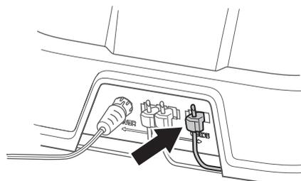
3. Fare uscire il cavo guida di almeno 2 metri dal bordo anteriore della piastra di ricarica.
