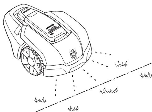
Il pulsante **STOP** sulla parte superiore del rasaerba robotizzato è utilizzato principalmente per fermare il rasaerba quando è in funzione. Premendo il tasto **STOP**, si apre uno sportello che consente di accedere al pannello di comando. Il tasto **STOP** rimane inserito finché non si richiude lo sportello. In tal modo funge da fermo di avviamento.
