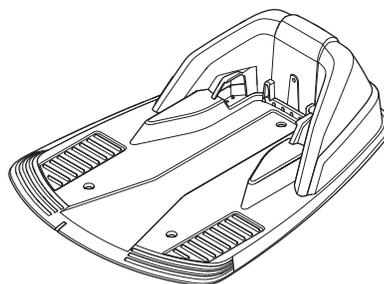
2. Verificare che i collegamenti del cavo perimetrale alla stazione di ricarica siano effettuati correttamente e non siano difettosi. Verificare che la spia della stazione di ricarica sia ancora blu e lampeggiante.
